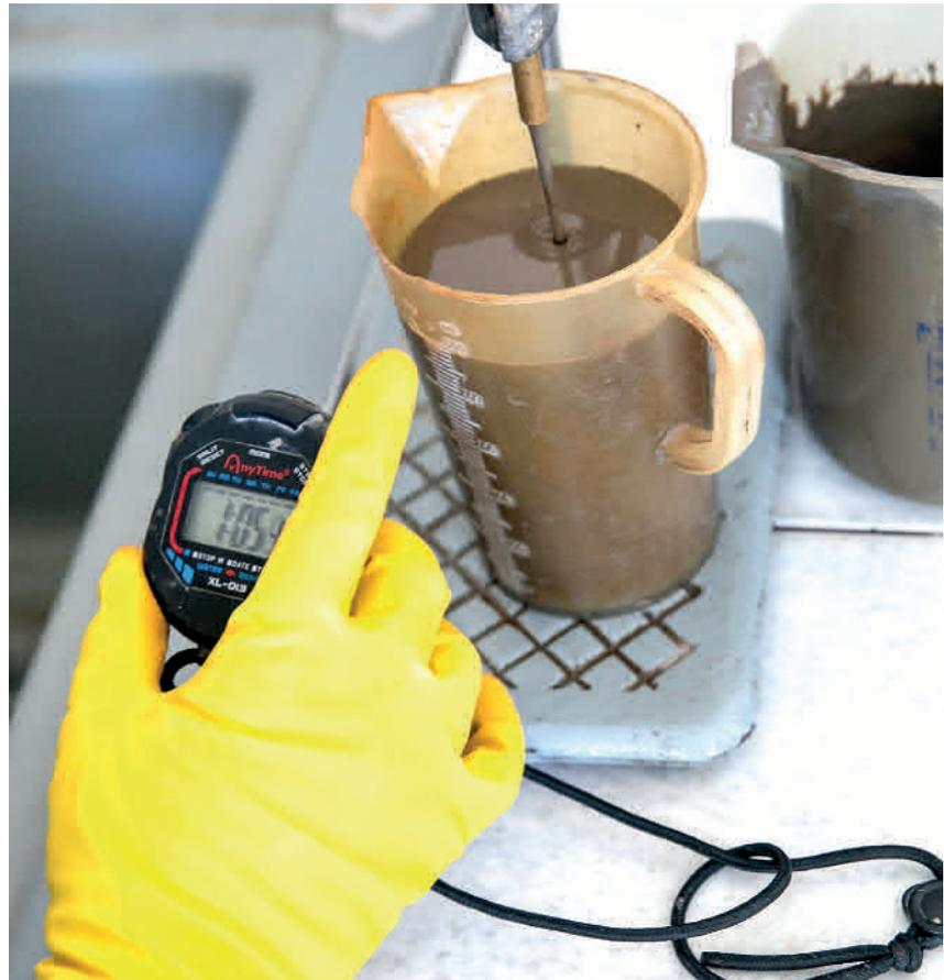
Определение параметра условной вязкости раствора
