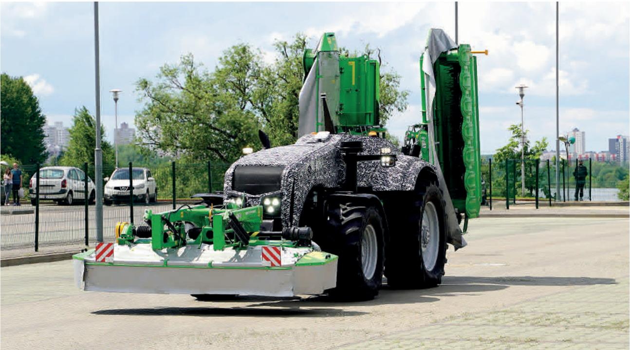
**Макетный образец энергонасыщенного автономного трактора BELARUS-3523i**
