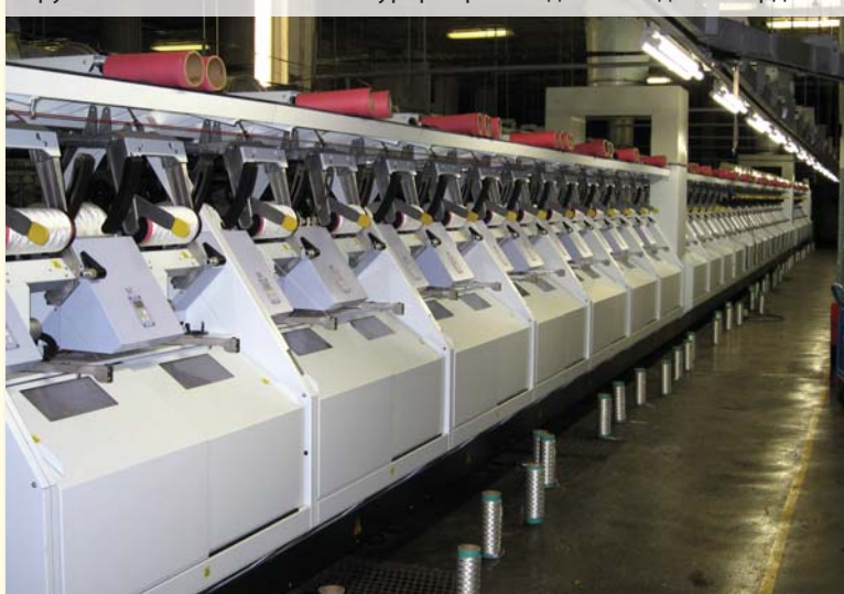
Крутильная машина «Альма-Заурер» производства анидного корда.
