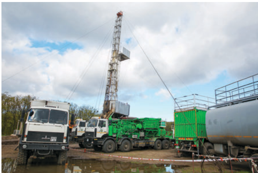
Проведение гидроразрыва пласта флотом Тампоного управления
