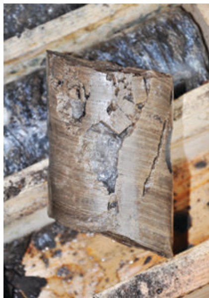
Рисунок 2. – Скважина № 281 Осташковичская (глубина – 2 515–2 523 м), известняк биогермный, каверны и трещины заполнены солью
