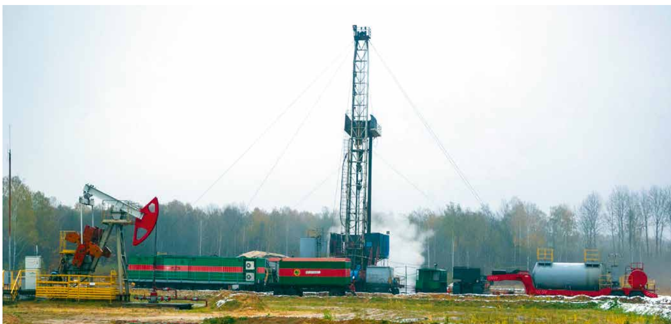
УПНПиРС. Восстановление скважины методом бурения бокового ствола
