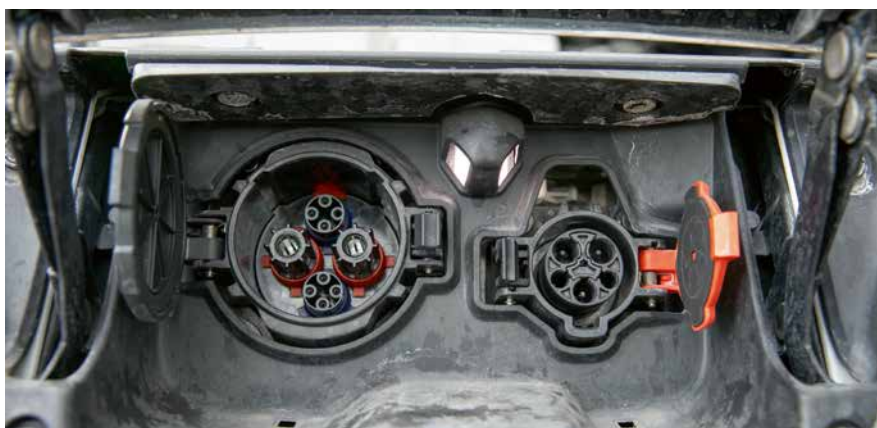
Одна из розеток предназначена для «быстрой» зарядки на АЗС, вторая (поменьше) – для «домашнего» пользования – получения энергии от бытовой электросети
