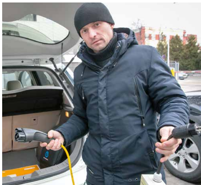
Длина шнура с коннектором достаточно только для того, чтобы заряжать аккумуляторную батарею от розетки либо в гараже, либо во дворе собственного дома
