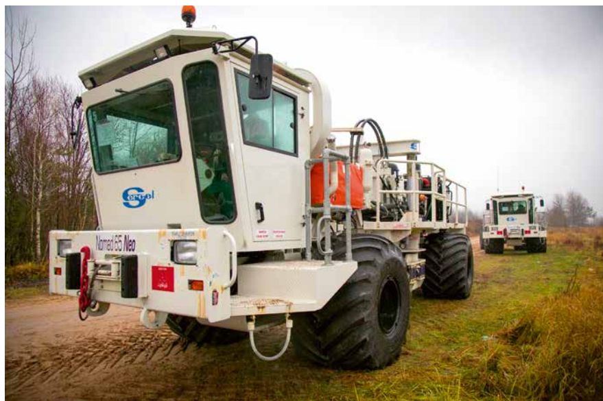
УПСР, Украина. Сейсморазведки оснащены современными виброисточниками сейсмических сигналов французского и белорусского производства
