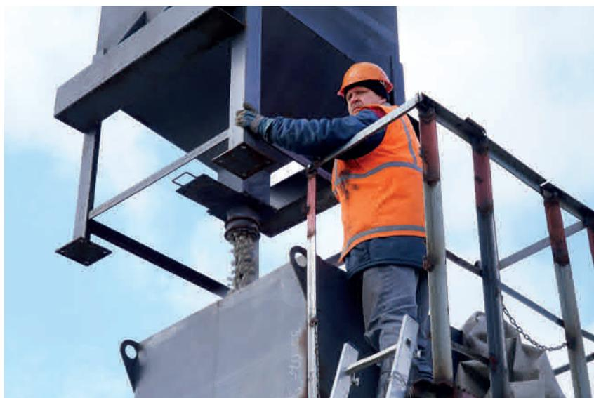
**Загрузка катализатора (шаров) через приемный бункер в реактор R-502**
