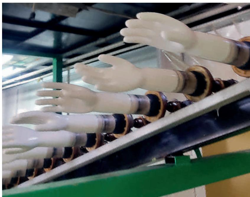
и снова сушится. Затем формы поочередно окунаются в четыре ванны с горячей водой, где происходит выщелачивание, и уже со сформованной перчаткой подаются в очередную печь-сушилку.
