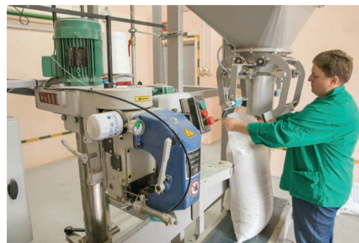
Линия фасовки комбикорма. Мастер Ирина МАЛАШКО проверяет работу оборудования после наладки
